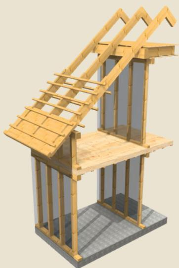
Das Rahmen-Panel-System in Kombination mit Brettsperrholzdecken ermöglicht eine schnelle und effiziente Montage. Holz als natürlicher Baustoff bietet hervorragende Wärmedämmung und trägt zur natürlichen Regulierung der Luftfeuchtigkeit bei. Gebäude in dieser Bauweise sind äußerst energieeffizient und nutzen häufig erneuerbare Energien wie Solarmodule, Wärmepumpen und Lüftungssysteme mit Wärmerückgewinnung.
